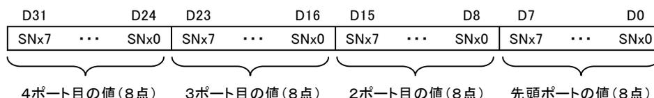
D0~7 ビットには先頭ポートの値を、D8~15 ビットには2ポート目の値を、D16~23 ビットには3ポート目の値を、D24~31 ビットには4ポート目の値を設定します。
