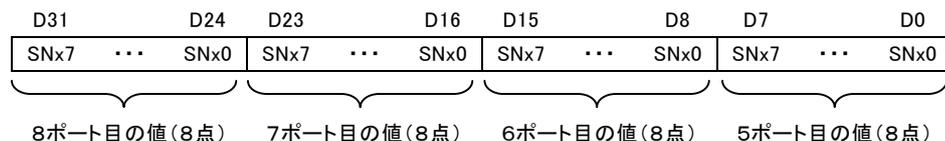
D0～7 ビットには5ポート目の値が、D8～15 ビットには6ポート目の値が、D16～23 ビットには7ポート目の値が、D24～31 ビットには8ポート目の値が入ります。下図の例のように、各ポートの値は変数に8ビットずつセットされ、その8ビットの最下位ビット～最上位ビットに対して SNx0～SNx7 信号(x はポート番号)の順にセットされます。
