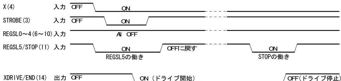
図B3 X 軸 REG32をインデックスドライブし STOP信号で途中停止させる例
