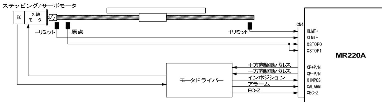
図 1.3 軸入出力信号の接続例
