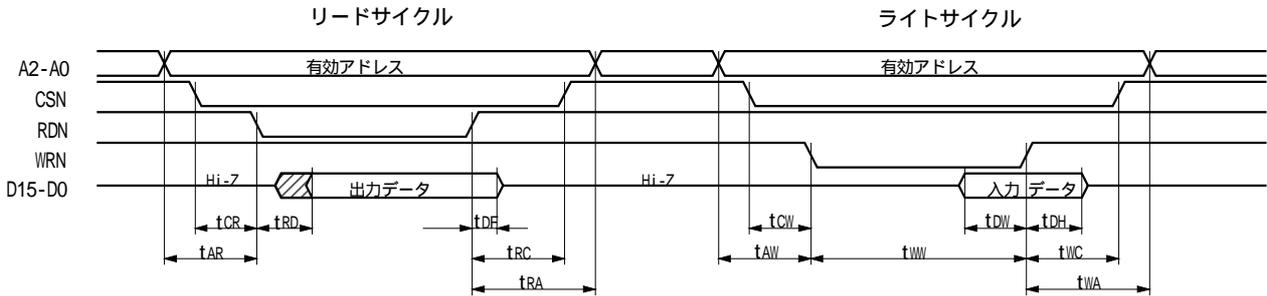
上図は、16ビットデータバス(H16L8=Hi)のときの信号です。8ビットデータバス(H16L8=Low)のときは、図においてアドレス信号がA3～A0、データ信号がD7～D0になります。
