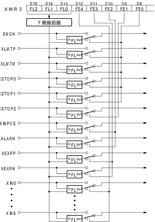
図2.45 入力信号フィルタ回路 概念図
