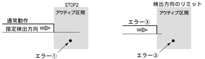
エンコーダZ相信号（nSTOP2）がアクティブへ立ち上がる時に、サーボモータ用に偏差カウンタクリア信号を出力させることができます。2.4.2節を参照してください。また、エンコーダZ相信号（nSTOP2）がアクティブへ立ち上がる時に、実位置カウンタ（EP）をクリアさせることもできます。2.3.4節を参照してください。
