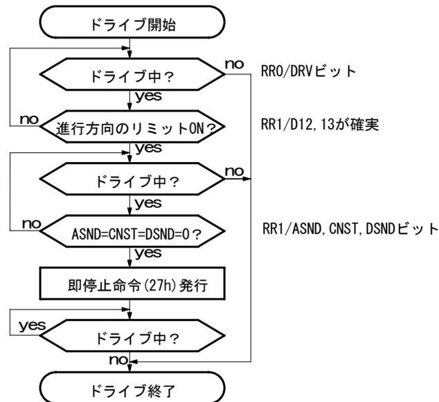
S字加減速の定量パルスドライブを開始したら、タイマー割込みなどで進行方向のリミット信号の状態(RR1/D12,D13)を常に読み出して、リミット信号がアクティブになった場合には、RR1のASND、CNST、DSNDビットを更に常に読み出して、これら3つのビットがすべて0の場合には即停止コマンド(27h)を一回だけ発行してやります。
