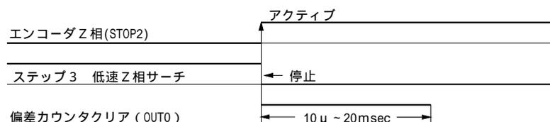
偏差カウンタクリア出力は、ステップ3のZ相検出動作終了と同時にアクティブになり、クリアパルス出力の終了を待ってからステップ4が開始されます。
