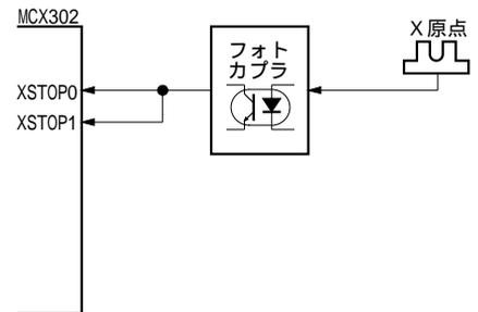
上表のように、ステップ1とステップ2の信号の論理レベルと検出方向は同じにします。(論理レベルを逆に設定する方法もあります。)
