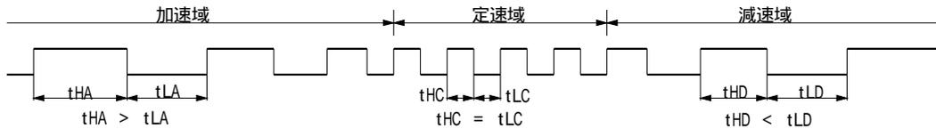
図2.16 加減速ドライブ時のドライブパルス幅比較
