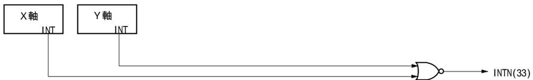
図2.40 IC 内の割り込み信号経路
