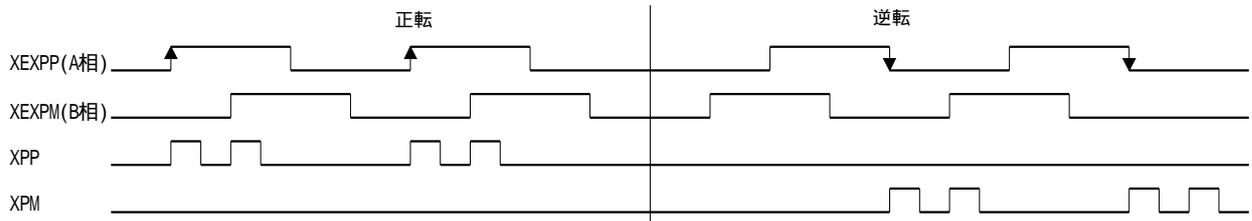
図2.44 手動パルサーによる出力パルス2のドライブの例
