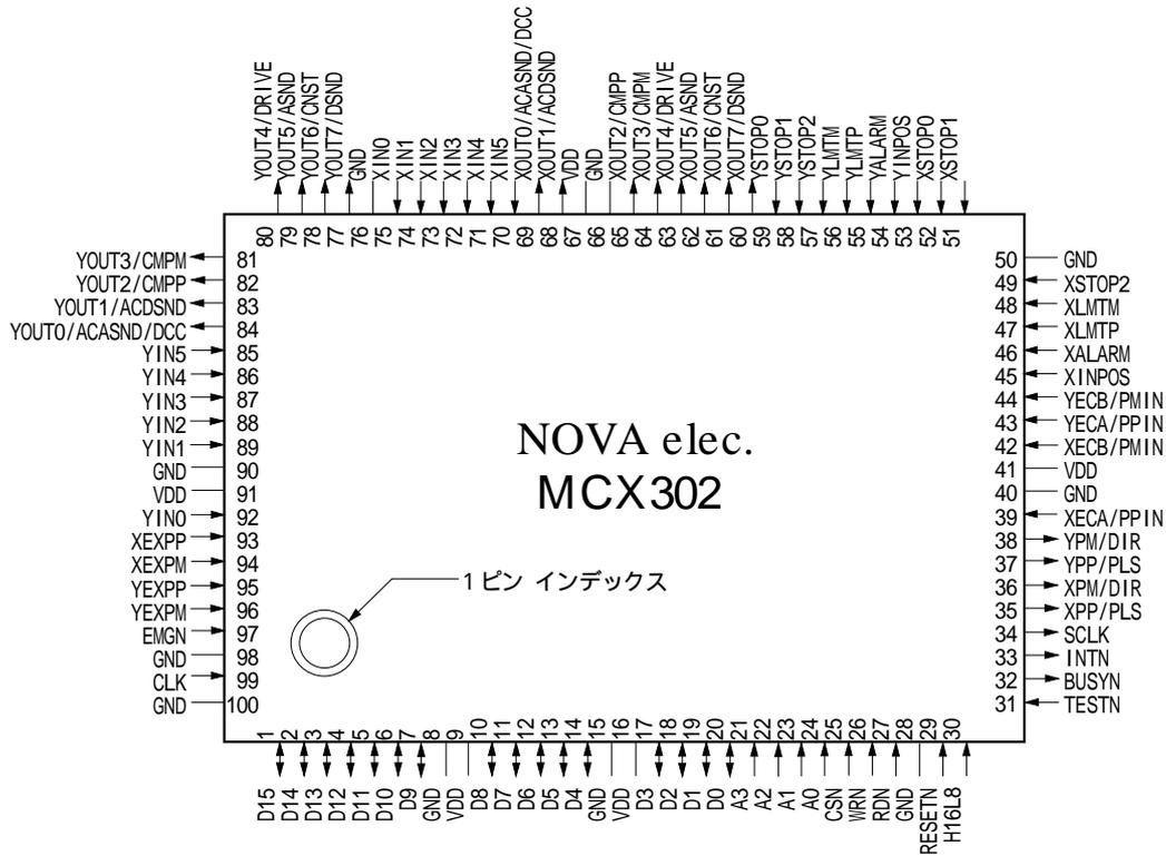
100pin QFP 外形：23.8×17.8 mm リードピッチ：0.65 mm
