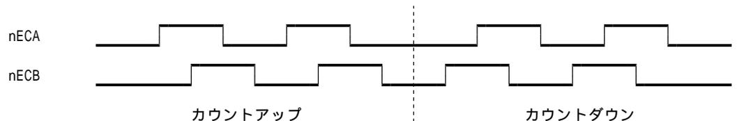
このビットをアップ/ダウンパルス入力のモードに設定すると、nECA/PPINが、カウントアップ入力に、nECB/PMINがカウントダウン入力になります。それぞれ、正パルスの でカウントします。
