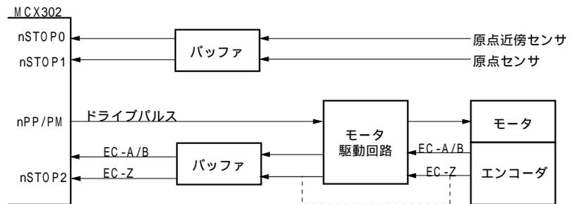
図2.21 STOP2信号による実位置カウンタクリアの信号接続例
