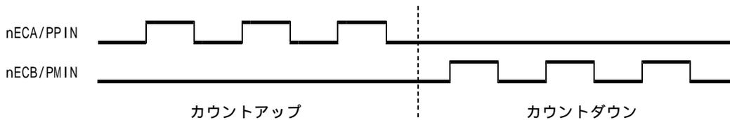
パルス入力方式の選択はWR2レジスタのD9(PINMD)ビットで、エンコーダ2相パルス入力の分周比はD11,10(PIND1,0)ビットでセットします。
