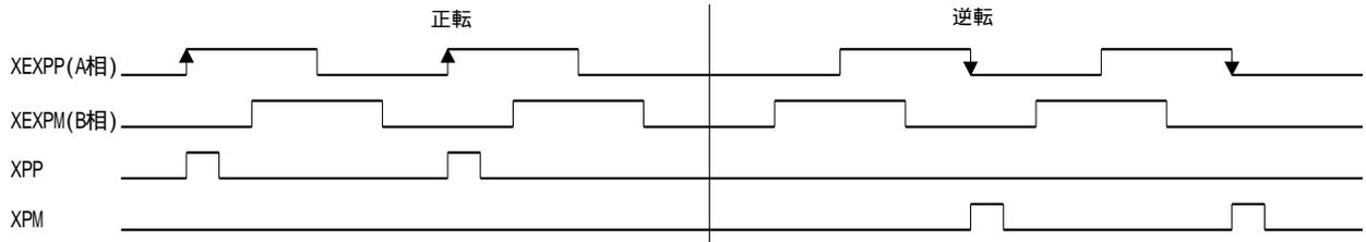
図2.43 手動パルサーによる出力パルス1のドライブの例
