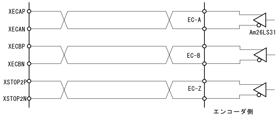
差動出力のラインドライバとの接続例
