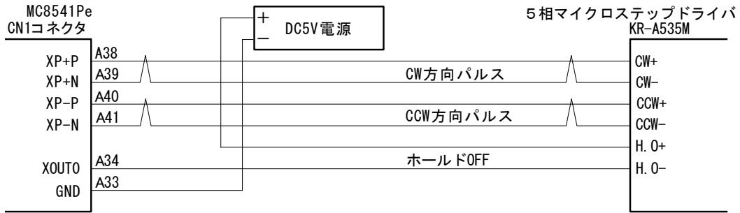
注1: ホールドOFFは必要に応じて配線します。ホールドOFF信号にXOUT0出力信号を使用の場合は、MCX514のWR4レジスタのD0ビットに0,1を書き込むことによって制御します。
