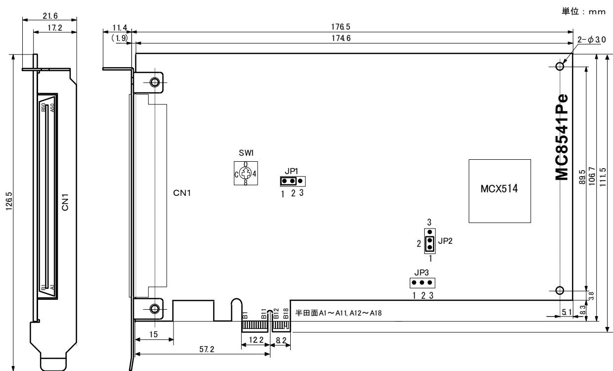
JP1: 緊急停止信号(EMG)のアクティブ論理を選択します。
