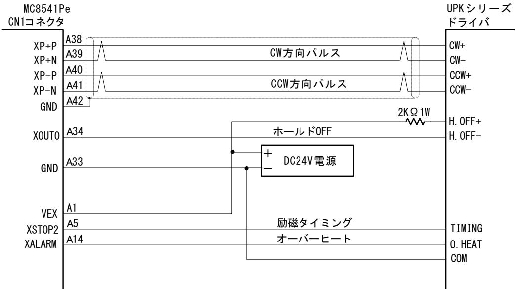
注1: ホールドOFF、励磁タイミング、オーバーヒート信号は必要に応じて配線します。ホールドOFF信号にはXOUT0出力信号を使用して制御できます。励磁タイミング信号にはXSTOP2入力信号を使用して、原点検出動作を行うことができます。オーバーヒート信号は、XALARM入力信号を使用してアラーム機能を働かせることができます。また、励磁タイミング、オーバーヒート信号は、RR3レジスタを通して直接信号レベルを読み出すことができます。
