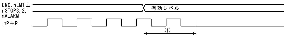
① ドライブ途中で外部停止信号が有効レベルになると、フォトカプラ遅延時間（最大100μsec）+ I C内蔵積分フィルタの遅延時間（初期値512μsec）+ 1 ドライブパルス後に停止します。
