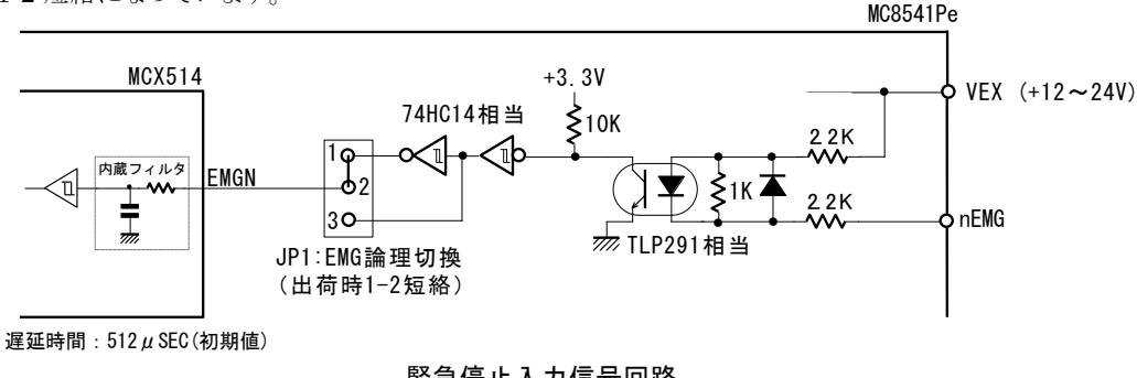
この信号を動作させるには、外部から DC+12~24V の電源供給が必要です。また、MCX514 内蔵の積分フィルタは、ノヴァエレクトロニクスより供給される Windows デバイスドライバの起動時初期設定において、遅延時間 512 μ sec に設定されます。システムのノイズ環境によって、この信号遅延時間を変更することができます。詳細は、MCX514 取扱説明書 2.11 節を参照してください。
