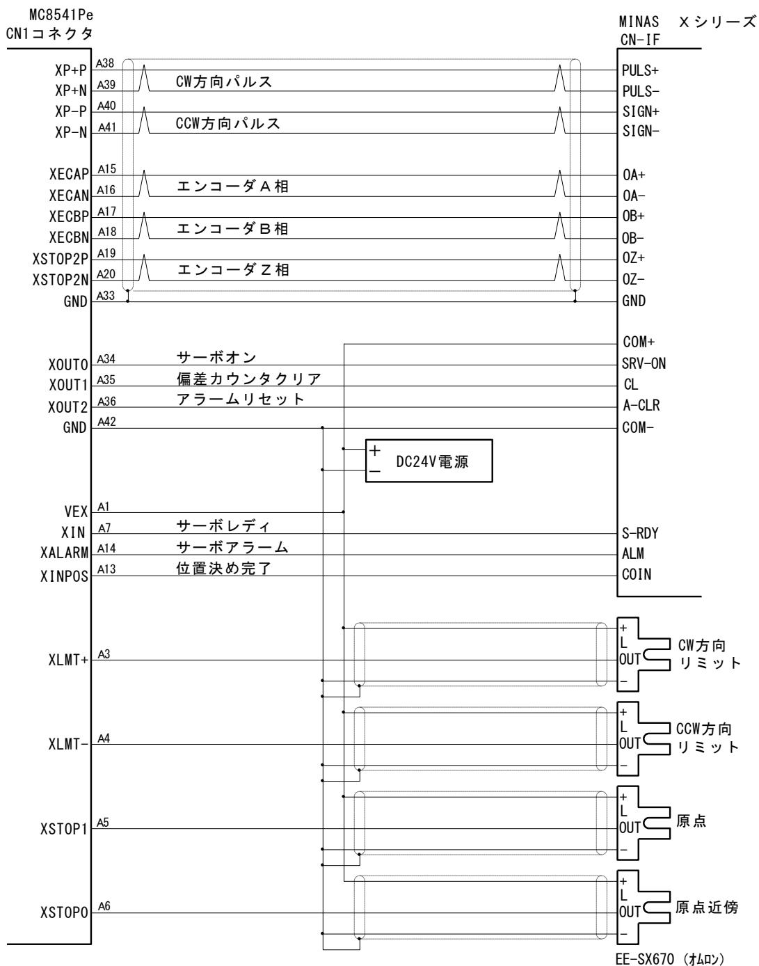
注1: ドライバの制御モード設定は位置制御モードに、指令パルス形態は CW/CCW パルスモードにパラメータセットします。
