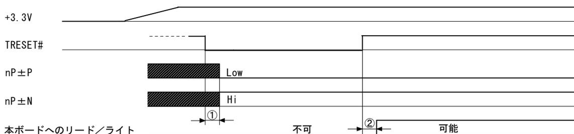
① ドライブパルス出力信号 (nP±P, nP±N) は、APIC21のターゲットリセット信号 (TRESET#) の↓から最大375nSEC以内に確定します。
