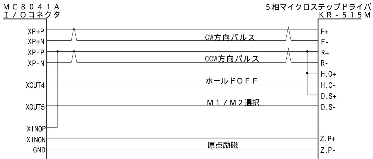
注1：MC8041AのJ3ジャンパーは、+5V出力側にセットし、XP+P,XP-P出力端子に+5Vを出力します。内部回路の電源出力ですので外部ノイズがのらないように配線には十分注意してください。
